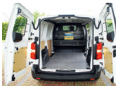
Ein Laderaumboden in grau mit Antirutsch-Oberfläche und Befestigungsösen gehört zur Sonderausstattung.
