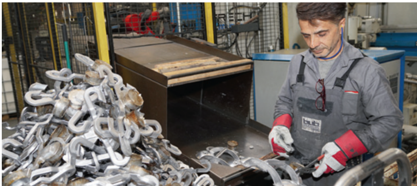
Hier werden die digital gelieferten Vorlagen umgesetzt: Diese Anlage preßt Trageteile für Scheiben in der Glasindustrie. (Foto: Peter Meuter)
