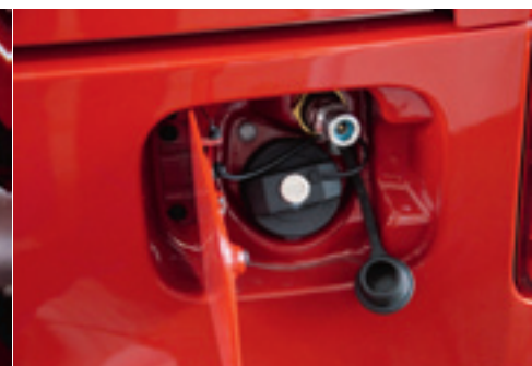
Einfüllstutzen für Superbenzin unten und für das komprimierte CNG-Erdgas oben.
