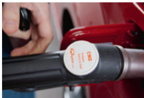
Die CNG-Zapfpistole, die sich mit dem Autoanschluß verriegelt, bevor das CNG in den Tank fließen kann.
