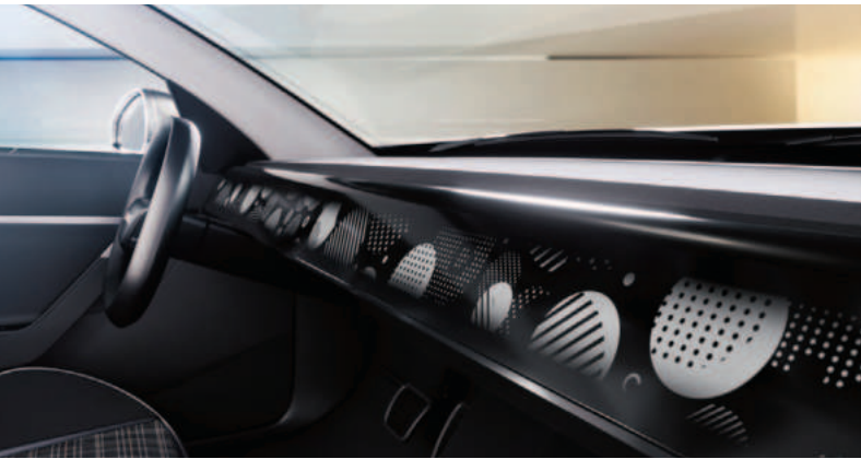
Das neue „Emotional Cockpit“ von Continental arbeitet mit einem 1,30 m langen und vier Zentimeter hohen E-Ink-Prismadisplay, das besonders energieeffizient ist. Bild: Continental
