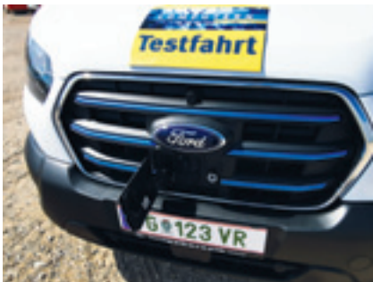
Der Ladeanschluß des E-Transit ist vorne im Kühlergrill unter dem Ford-Emblem
