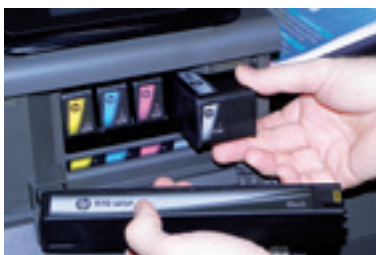
In den Schacht für die schwarze Tinte paßt alternativ eine extra-breite Patrone mit einer gigantischen Reichweite von 9200 Seiten.
