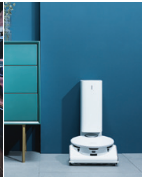
Der smarte Staubsauger von Samsung, der JetBot 90 AI+, ist bestückt mit LiDAR- und 3D-Sensoren sowie einer Kamera. (Quelle: Samsung)
