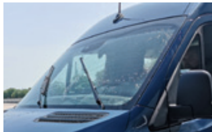
Das Wet Wiper-Sprühsystem spart Wischwasser und verteilt es direkter vor das Wischerblatt
