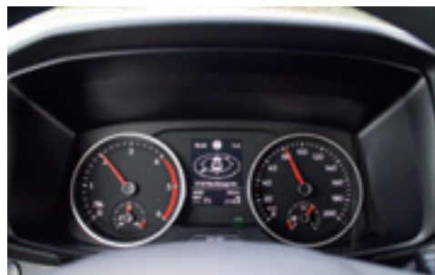
Das Ergebnis der Verkehrszeichenerkennung wird zwischen Tacho und Drehzahlmesser angezeigt!
