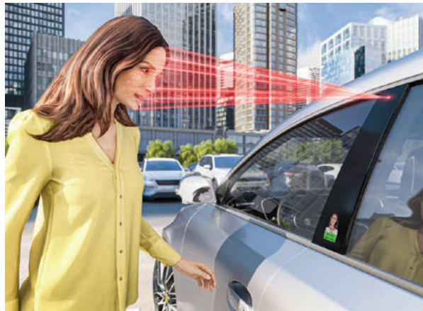
Continental hat mit „Face Authentication Display“ eine biometrische Entsperrung von Autos präsentiert. Sowohl in der B-Säule, als auch hinter dem Faberdisplay gibt es Kameras für die Gesichtserkennung. © Continental
