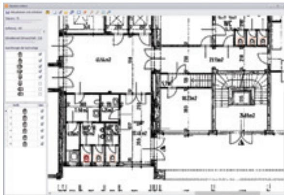
**Oben:** Der QTO Booster zählt sogar Objekte in Bilddaten: Der Nutzer legt eine „Suchvorlage“ fest, und die Software legt los.
