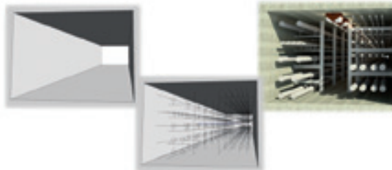
Verschiedene Entwicklungsstufen – ein leerer Versorgungsschacht, dann mit den Aufhängungen und dann mit den Leitungen.
