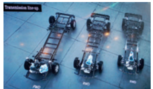
3 Antriebskonzepte mit den Getrieben
