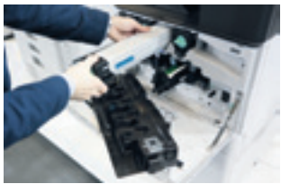
Unter der großen Frontklappe ist ein riesiger Resttonerbehälter (im Foto unten liegend), hinter dem sich die vier großen Toner-Behälter (oben) und vier schnell herausnehmbare Trommeln befinden. (Alle Fotos: Pernsteiner)
