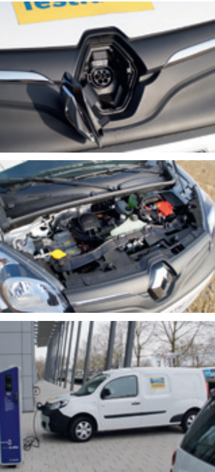
Bild oben: Die Ladeklappe hinter dem Renault-Rhombus. Mitte: Der platzsparende Elektromotor. Unten: Laden des Kangoo Z.E. an der Karlsruher EnBW-Zentrale.
