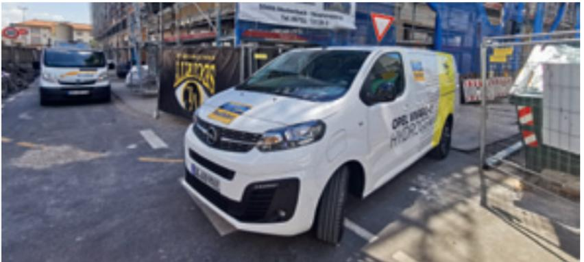
Opel Vivaro-e HYDROGEN als Lösung für Handwerker, die mit ihrem Transporter emissionsfrei weite Strecken absolvieren oder schnell auftanken wollen. Der elektrisch fahrende Vivaro-e HYDROGEN verfügt über einen Wasserstoff-Brennstoffzellenantrieb mit zusätzlicher Lithium-Ionen-Batterie. Vollgetankt fährt er bis zu 400 km weit (gemäß WLTP). Das Auftanken mit Wasserstoff dauert 3 Minuten. Dazu bietet er bis zu 6,1 m<sup>3</sup> Ladevolumen, 1.000 kg Zuladung bzw. 1.000 kg Anhängelast.
