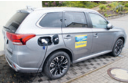
Ladekabelanschluß und Tankstutzen kennzeichnen Hybridfahrzeuge, weil sie sowohl Strom, als auch Verbrennungsenergie nutzen. (Foto: Sanders)
