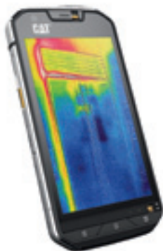
Wärmelecks etwa bei Fenstern spürt die Wärmebildkamera auf und zeigt Temperaturdifferenzen mit verschiedenen Farben an.
