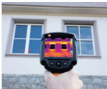
... und teilweise auch für die Ortung von Wärmebrücken an Fenstern und Haustüren einsetzbar (Testo)
