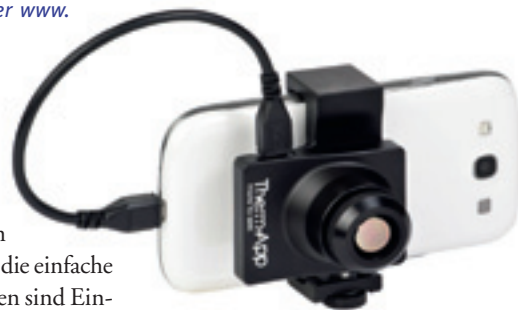
Auf das Smartphone aufsteckbare IR-Kameraaufsätze nutzen das Smartphone-Display für die Wärmebild-Anzeige (Opgal Optronic Industries)
