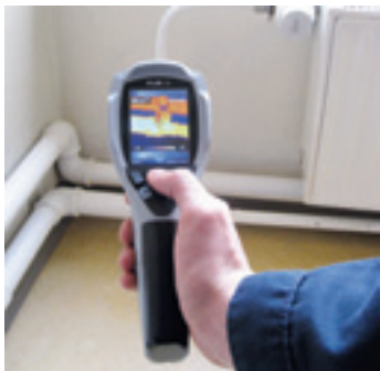
Kompaktkameras der Einstiegsklasse sind für die Leitungs- oder Leckagesuche, für die vorbeugende Instandhaltung der Gebäudetechnik ... (FLIR)
