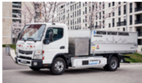
Bei den Stuttgarter Gartenbaubetrieben im Test: Sechstonner Fuso Canter E-Cell (Foto: Daimler)
