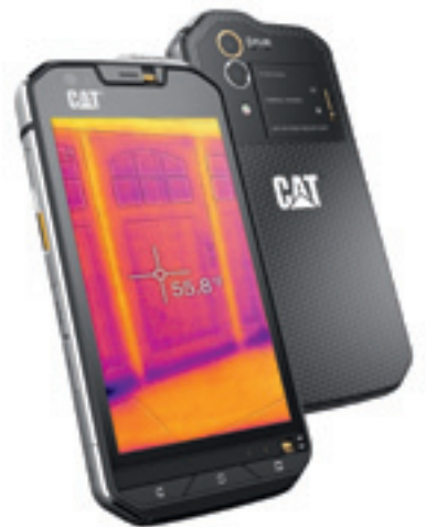
Rugged-Smartphone siebt rot: Mit Hilfe eines zusätzlichen IR-Detektors kann man nicht nur fotografieren, sondern auch Wärme visualisieren (CAT)
